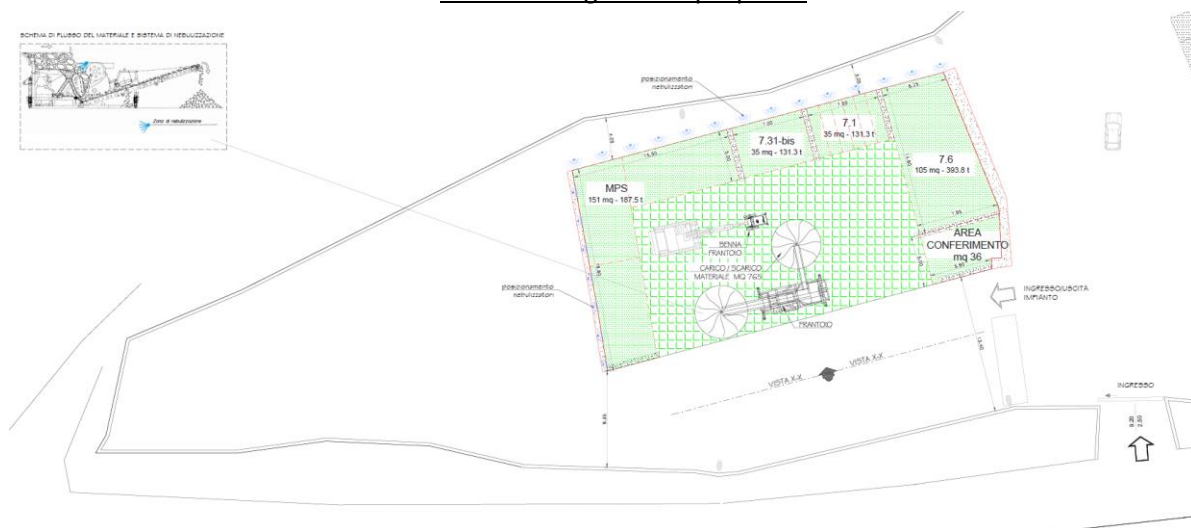
Planimetria impianto con indicazione dell'ingresso/uscita e dettaglio dell'impianto di frantumazione
